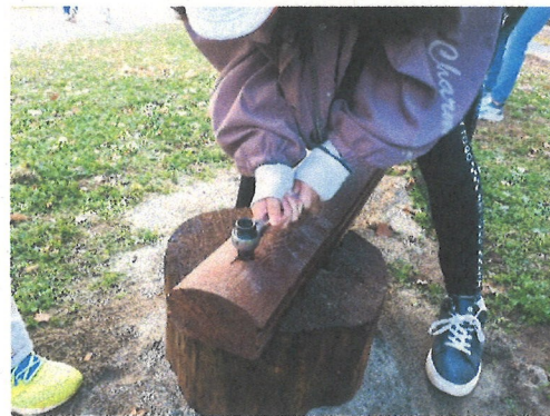
図21 コーチボルトによる固定作業
